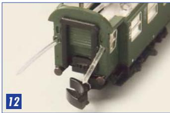
Die nach aussen ragenden Lichtleiter (Bild 12) mit einem Seitenschneider abschneiden. Eine saubere Schnittfläche der Lichtleiter ergibt einen besseren Lichtaustritt!
