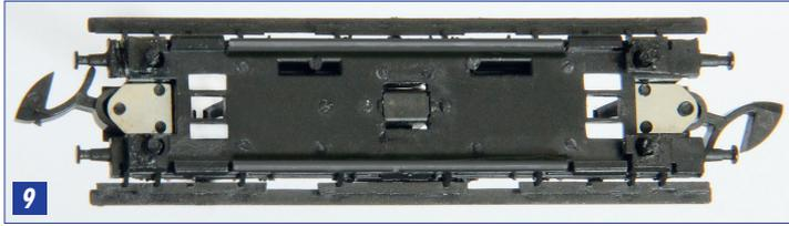
Stromabnehmer STA-Z-RW-13 in den Wagenboden einsetzen (Bilder 10 und 11). Stromabnehmer so einsetzen, dass die Bezeichnung "B" des Stromabnehmers auf der Seite "B" des Wagenchassis liegt!
