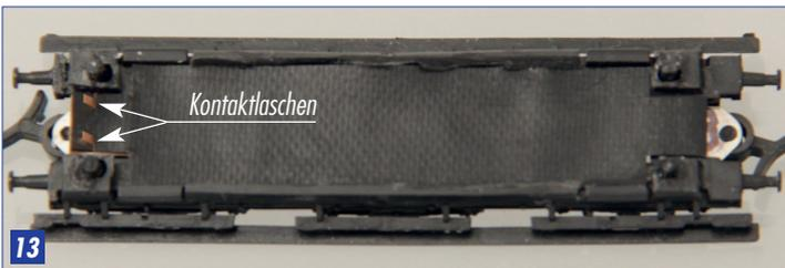
An den beiden Anschlusslaschen (Bild 13) wird zum Beispiel die mobatron Wagenbeleuchtung angeschlossen.
